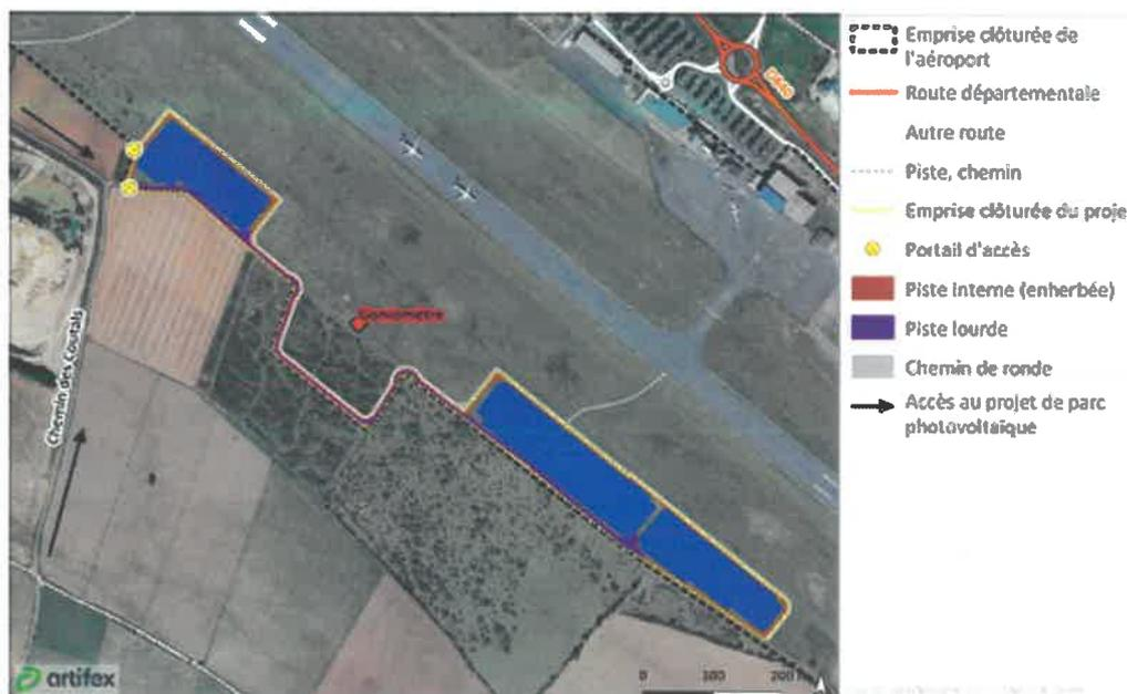
Figure 87 : Accès au parc photovoltaïque de Salles-la-Source
